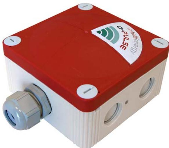
Le sonde wireless A-PULSE IPW02 e IPW04-1UD, insieme ai Ricevitori / Gateway IE-LoRa-GW01 e IE-LoRa-GW02, permettono di acquisire ingressi impulsivi a contatti liberi da potenziale (S0) o anche in tensione (IPW04). Le sonde utilizzano la tecnologia di trasmissione prevista dallo standard LoRa®, che garantisce un'ampia copertura, senza la necessità di ripetitori di segnale.
