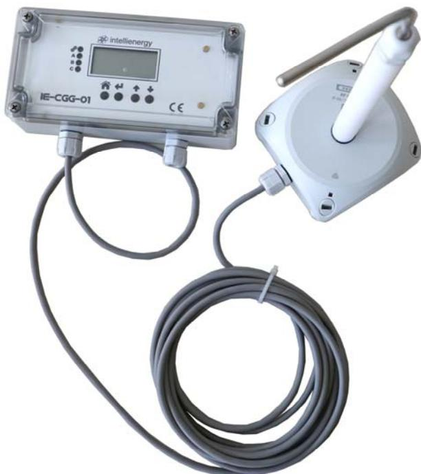
Il dispositivo **IECGG** è una unità di misura di precisione della Temperatura Esterna, un Misuratore/Registratore di Gradi Giorno secondo il DPR412/93 e di Gradi Giorno Reali. Il dispositivo è costituito da due elementi:
