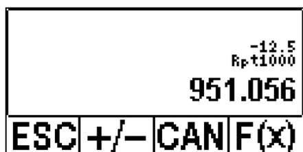
Il display mostra il risultato. Un sensore PT1000 a -12,5°C dovrebbe avere una resistenza di 951Ω.
