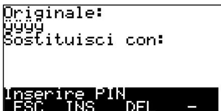
Dopo aver scelto IMPOSTA PIN il controllore propone di inserire il vecchio PIN (che non viene mostrato) con un NUOVO PIN.
