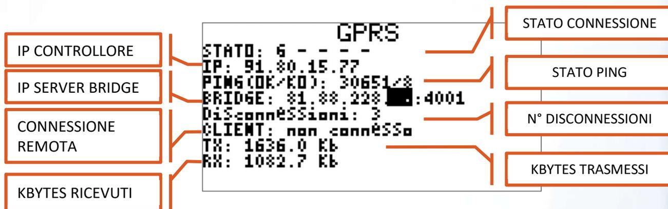
Figura 22 - FINESTRA DI STATO GPRS
