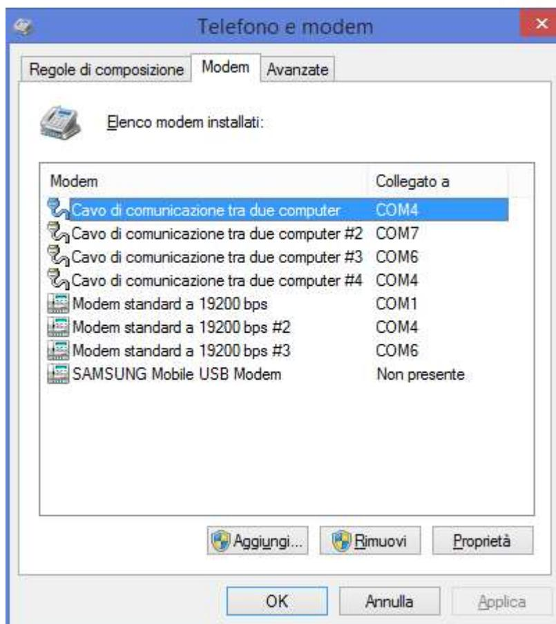
Nella lista dei modem installati adesso è presente anche il nuovo modem: fare click sul pulsante “OK” per chiudere la finestra. Nella finestra del pannello di controllo precedentemente aperta selezionare la voce “Centro connessioni di rete e condivisione”: vengono visualizzate le connessioni di rete disponibili.
