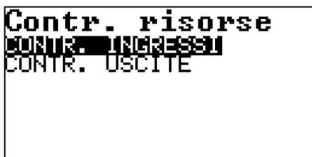
Appare l'elenco dei tipi di risorse che è possibile controllare. Con i tasti ⤴ e ⤵ seleziona il tipo di risorsa. Si possono controllare INGRESSI e USCITE. Premere ↓↑ per confermare la scelta.
