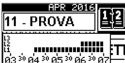
Nell'esempio è mostrato come il modello PROVA preveda che il calendario indichi il livello 0 fino alle 4; a quell'ora passa a livello 1 e permane a questo livello fino alle 6, quando passa a livello 2.
