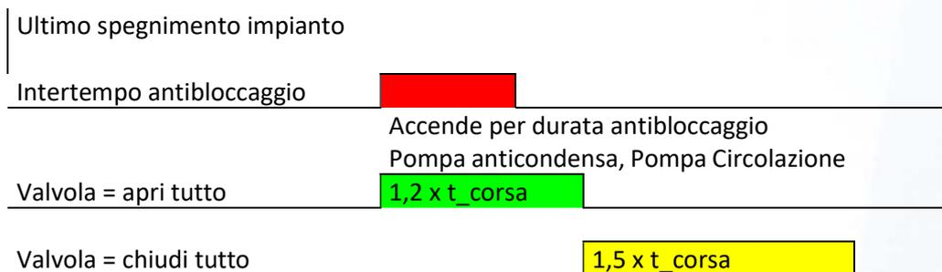
Figura 19 - FUNZIONE ANTIBLOCCAGGIO
