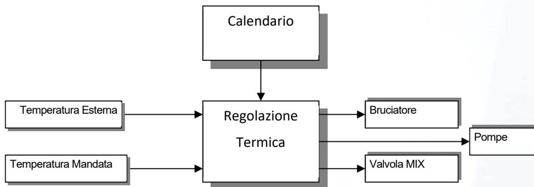
Figura 17 - SCHEMA DI PRINCIPIO DI UNA REGOLAZIONE TERMICA
