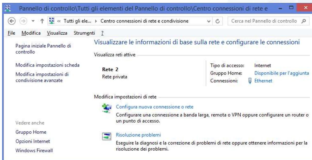
Per creare la nuova connessione selezionare la voce "Configura nuova connessione o rete".
