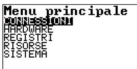
Il menu **CONNESSIONI** permette di configurare il modo con il quale il Centro Operativo e il controllore comunicano.
