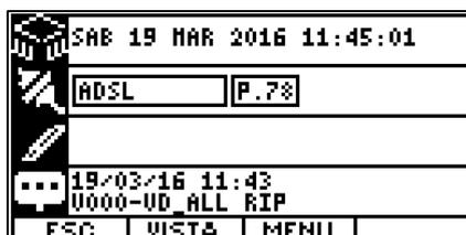
Quando il controllore si trova sul menu principale, la pressione del tasto **F1** funziona da commutatore ACCESO/SPENTO per la retroilluminazione;
