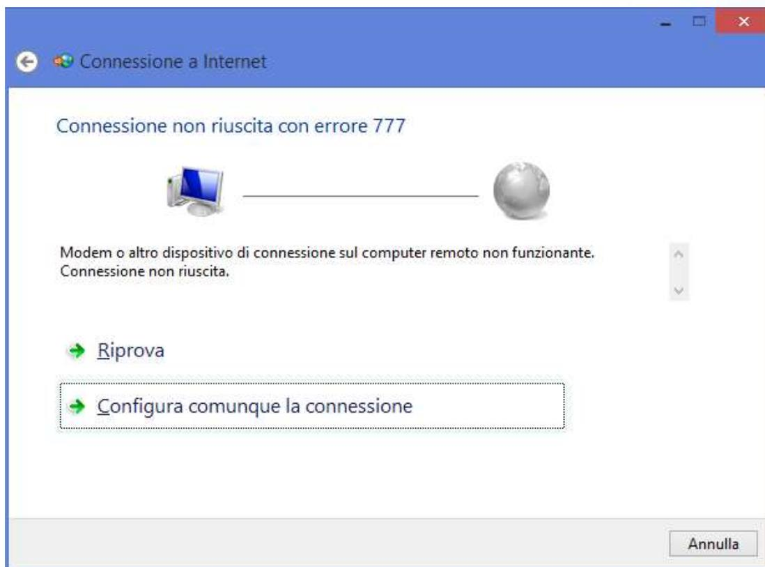
Dopo alcuni secondi verrà restituito un errore di connessione: selezionare l'opzione “Configura comunque la connessione”.
