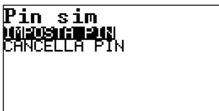
Con questo menu si può impostare o cancellare il PIN memorizzato nel controllore per l'accesso alla SIM del modem.
