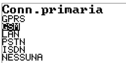
Per abilitare la connettività GSM, dal menu CONNESSIONI, selezionare Connessione Primaria e scegliere GSM.
