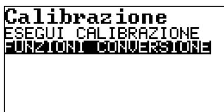
Una volta entrati nel menu CALIBRAZIONE selezionare **FUNZIONI DI CONVERSIONE** e premere OK.
