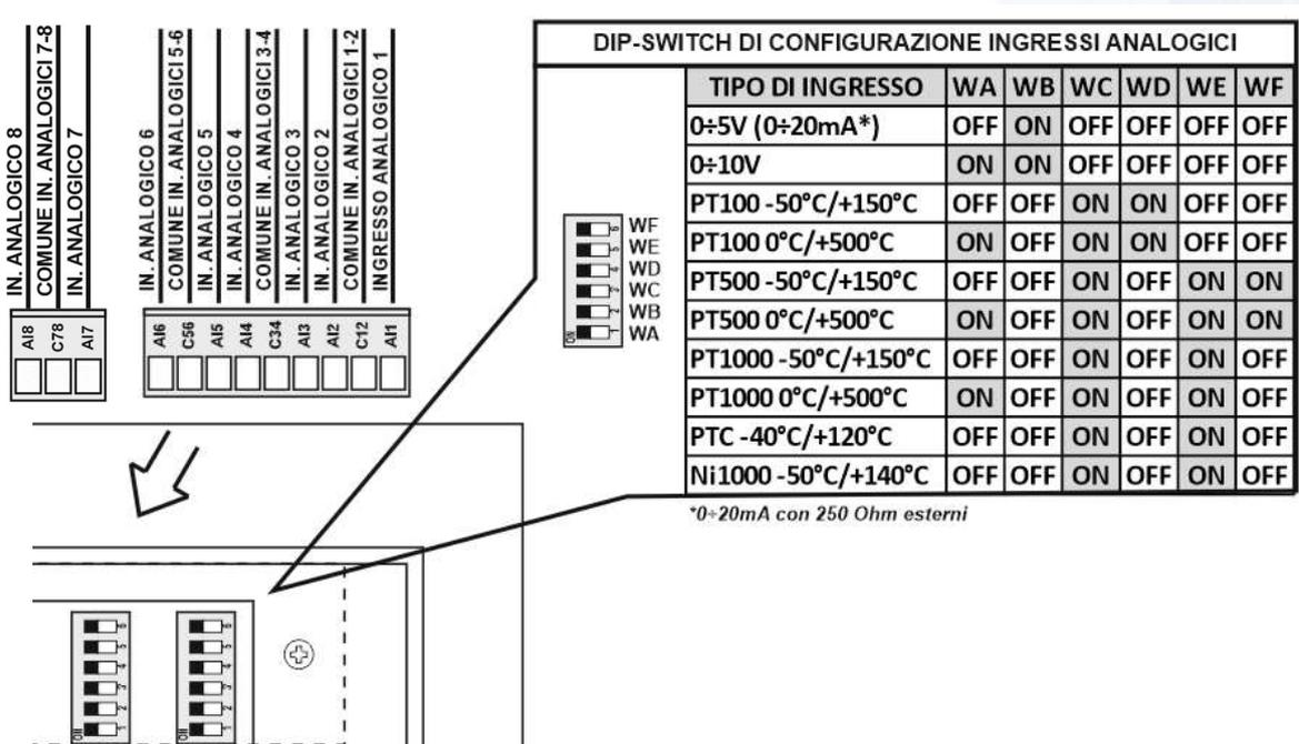
Figura 7 - INGRESSI ANALOGICI DEL CONTROLLORE ICON200
