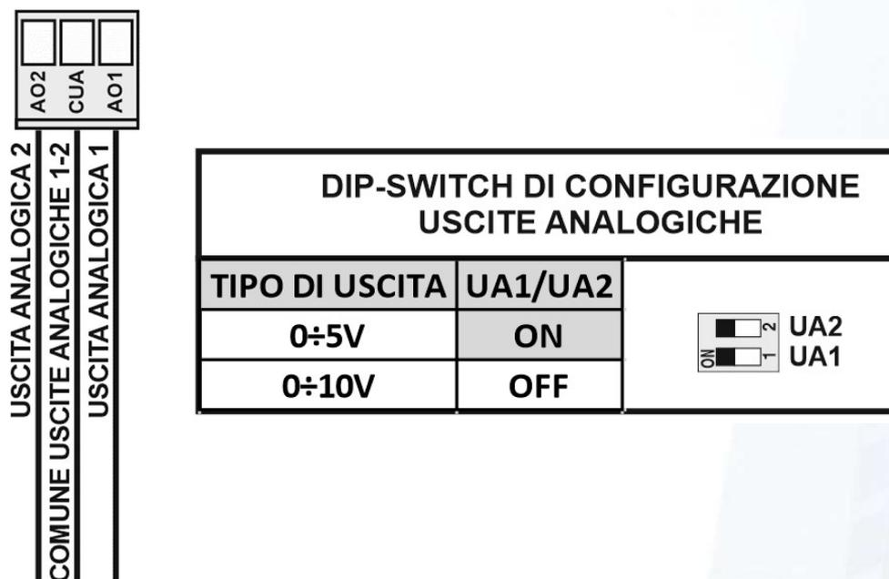
Figura 12 - USCITE ANALOGICHE DEL CONTROLLORE ICON200
