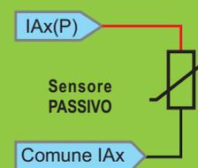
I moduli IREM70 hanno una configurazione di fabbrica per cui tutti i morsetti sono configurati come **INGRESSI PT1000 -50/+150°C (TIPO 2):**
