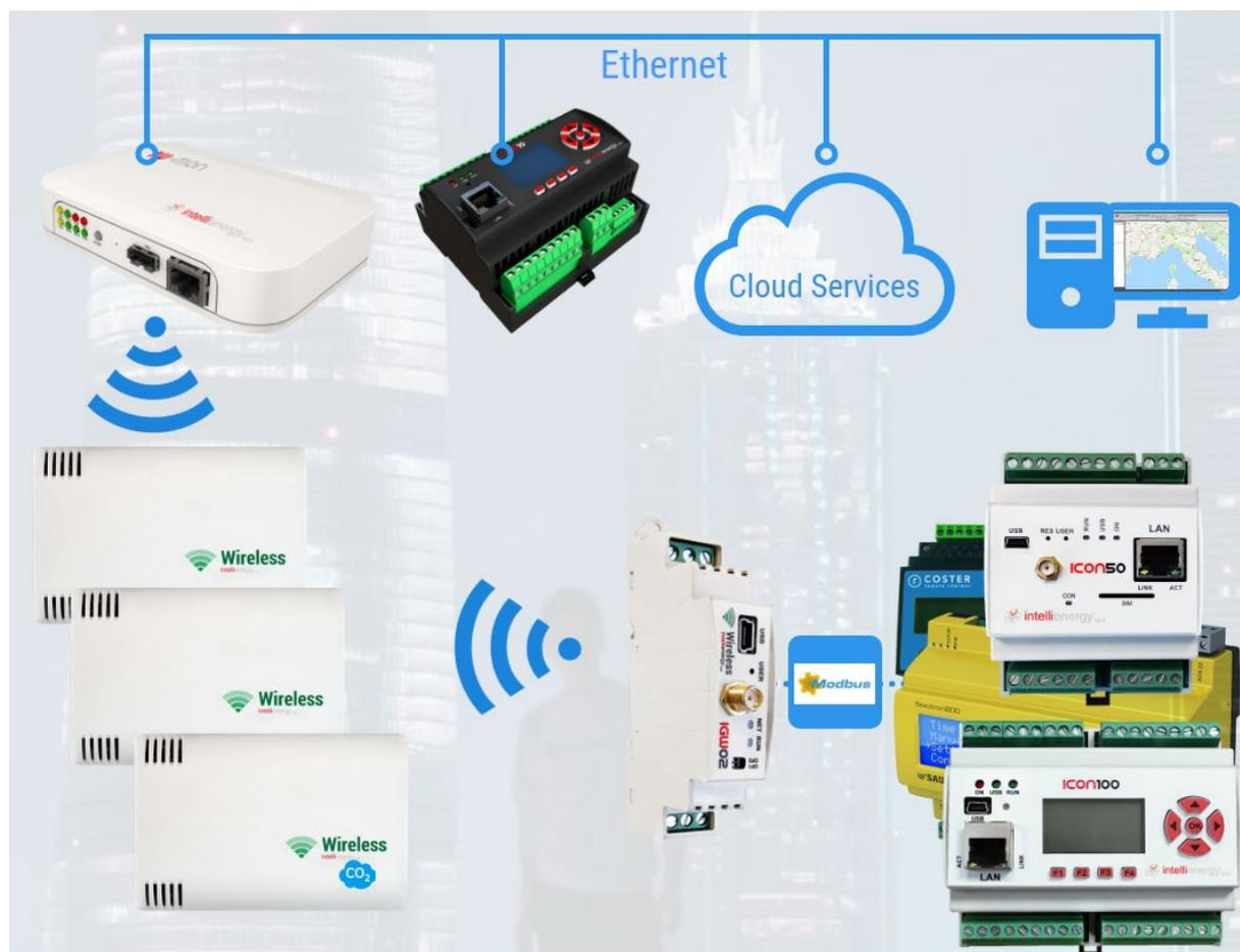
Il sistema wireless intellienergy può essere realizzato con diverse architetture funzionali, può essere impiegato in edificio per il monitoraggio ambientale, utilizzando IW-MON connesso alla rete LAN di edificio, o tramite l'infrastruttura wireless di edificio.
