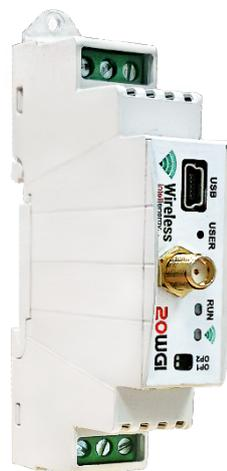
Si presta ad essere utilizzato in molteplici situazioni, ogni qualvolta non sia possibile o conveniente utilizzare un cablaggio di campo. Con 20WGI si possono acquisire dati di dispositivi di qualsiasi tipo, con abbiano a bordo una porta RS485 con Modbus.
