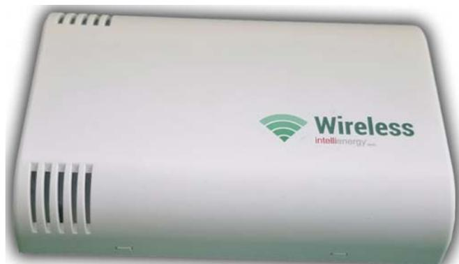
Le sonde wireless WSLR00TC, WSLR00TC, WSLR00THC, WSLR00TH, insieme ai Ricevitori / Gateway IE-LoRa-GW01 e IE-LoRa-GW02, permettono di acquisire e centralizzare le informazioni di temperatura e umidità (relativa) degli ambienti nei quali sono installate. Le sonde utilizzano la tecnologia di trasmissione prevista dallo standard LoRa®, che garantisce un'ampia copertura, senza la necessità di ripetitori di segnale.
