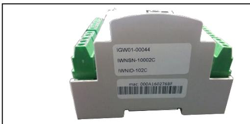
Il CR dell'esempio precedente è stato impostato di fabbrica con IWN-ID pari a 0x102C (cioè in decimale 4140). Si tratta quindi di un CR operante in **RETE SICURA** il cui IWNID non può essere modificato con gli strumenti standard di configurazione.
